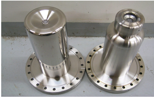
図4. 電子銃ウェーネルト電極形状。左が新電子銃、右が旧電子銃。新電子銃は旧電子銃に比べ径の小さいEIMAC Y646B カソードが取り付けられている。
