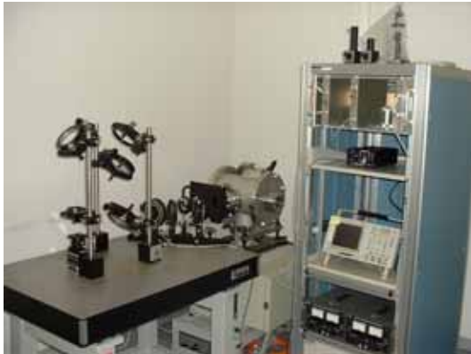
Fig.1. LEBRA-FEL 照射実験装置。 左側部分に反射鏡と収束レンズ、試料微動装置が設置されている。右側に照射回数制御装置、照射エネルギー監視装置が置かれている。
