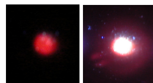
紫外レーザー光照射で起こる \text{Eu}_2\text{O}_3 の赤色-白色発光転移(室温実験)
