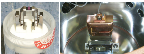
図4. LaB 6 陰極と陽極。左が単結晶LaB 6 陰極、右は銅製の陽極。LaB 6 はグラファイトを介して固定されている。陽極は陰極の正面からレーザー光を照射できるように切りかきがある。
