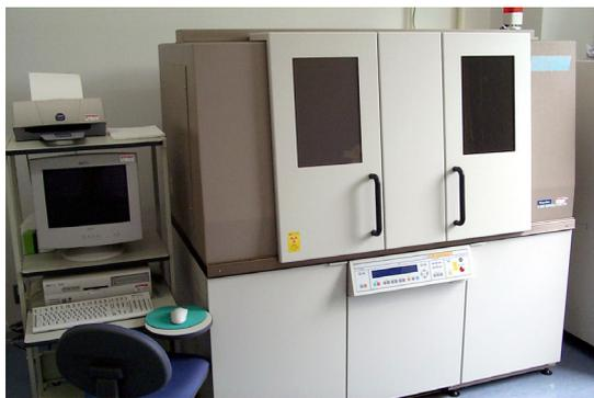
粉末・薄膜 X 線回折装置
