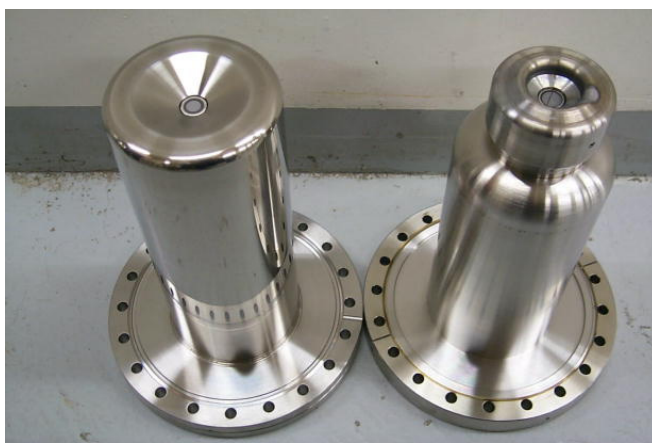
写真13 新電子銃(左)と旧電子銃(右)
