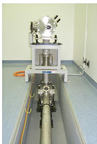
写真17 新実験棟に建設中のレーザービームライン(左)とレーザービームラインと接合したレーザー取り出し装置(右)。
