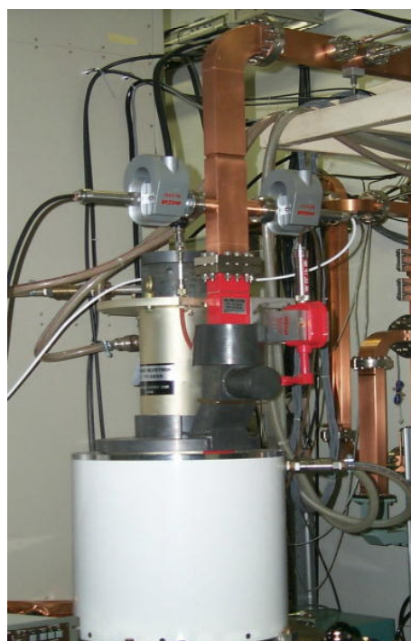
写真6 改良後のクライストロンの出力窓周辺に取り付けられたイオンポンプ。
