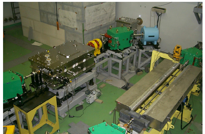
写真10 パラメトリックX線発生装置(左)とFEL発生装置(右)
