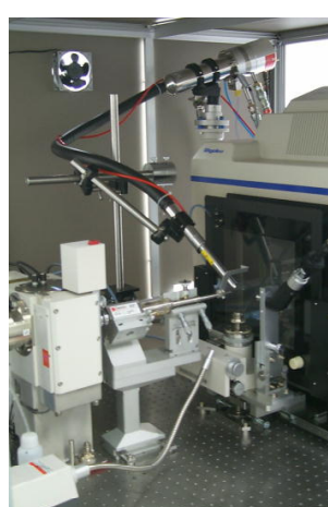
写真18 資料分析室に設置中の予備実験用タンパク質自動X線高次解析装置の資料分析部(左)と予備実験用拡張型粉末X線回折装置の全体(右)。
