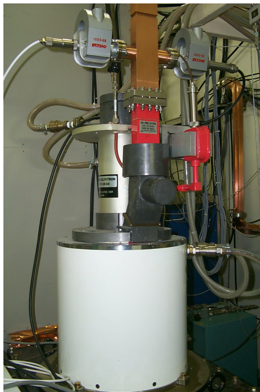
図1 イオンポンプ強化の立体回路の構成による長パルス運転に成功したクライストロン
