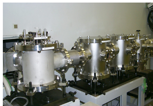
写真 ビームレーザーラインに設置されたFELモニター
