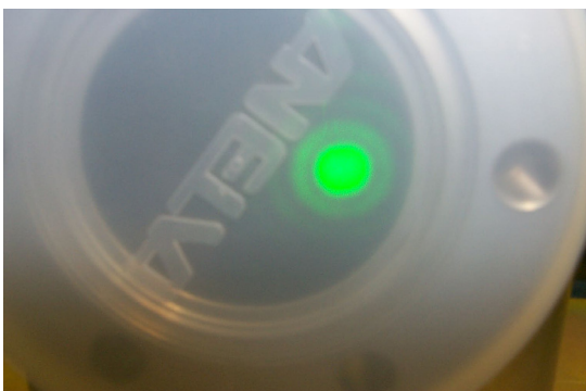
図7 加速器室の放射線シールド壁のペネレーションダクトの出口（実験室側）のレーザー回折像
