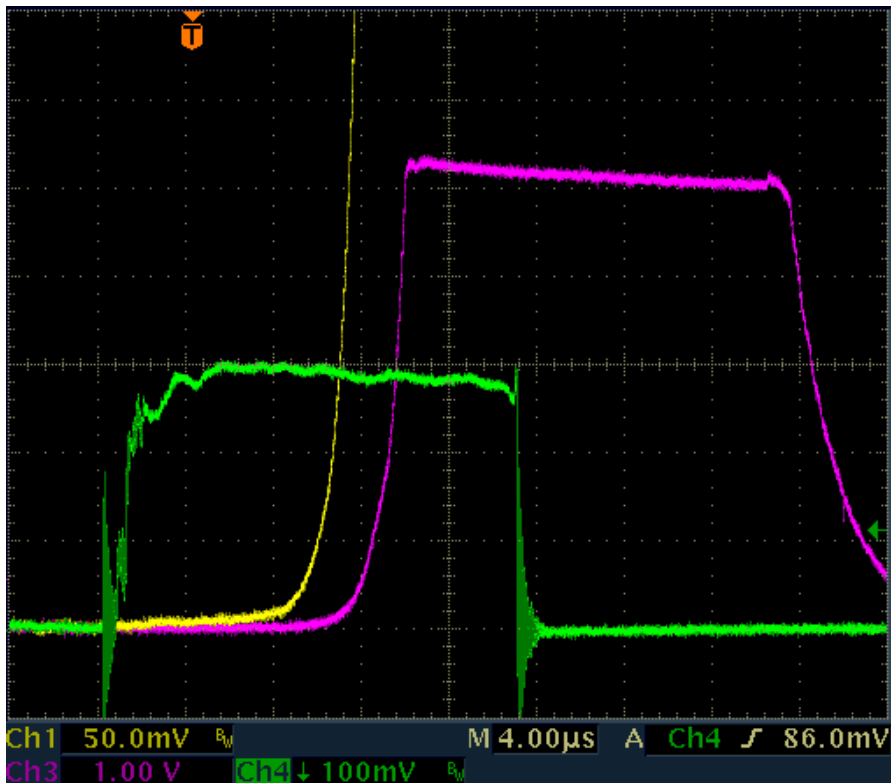
図4 1.5 \mu\text{m} の自由電子レーザー発振状態。垂直軸：ビーム電流波形（緑）、高増幅度で測定した光強度波形（黄）、低増幅度で測定した光強度波形（桃）は増幅器が飽和した状態。水平軸：4 \mu\text{s}/\text{div} 。
