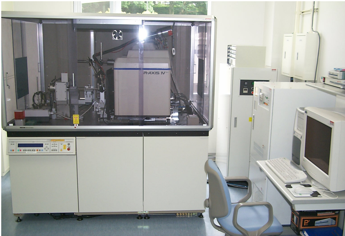
写真 8 資料分析室 4 に設置された予備実験用タンパク質 X 線自動解析装置
