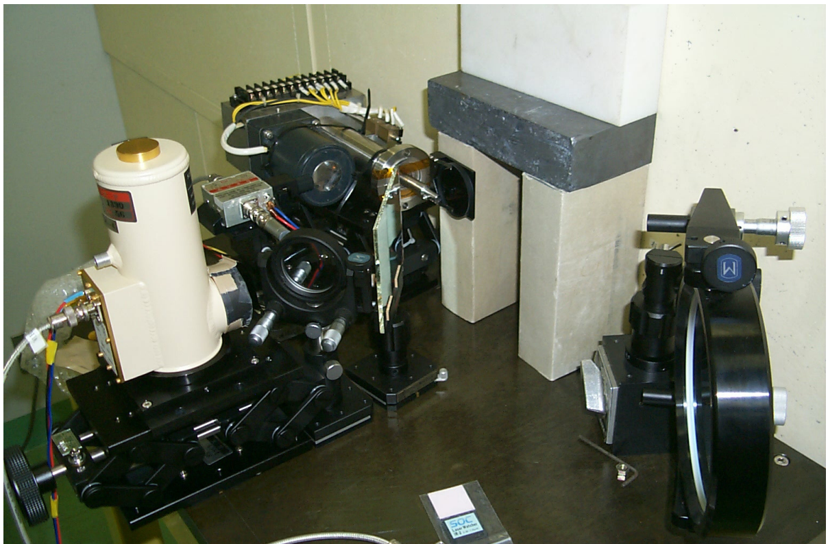
写真15:高感度赤外線検出器（白）と光学システム。
