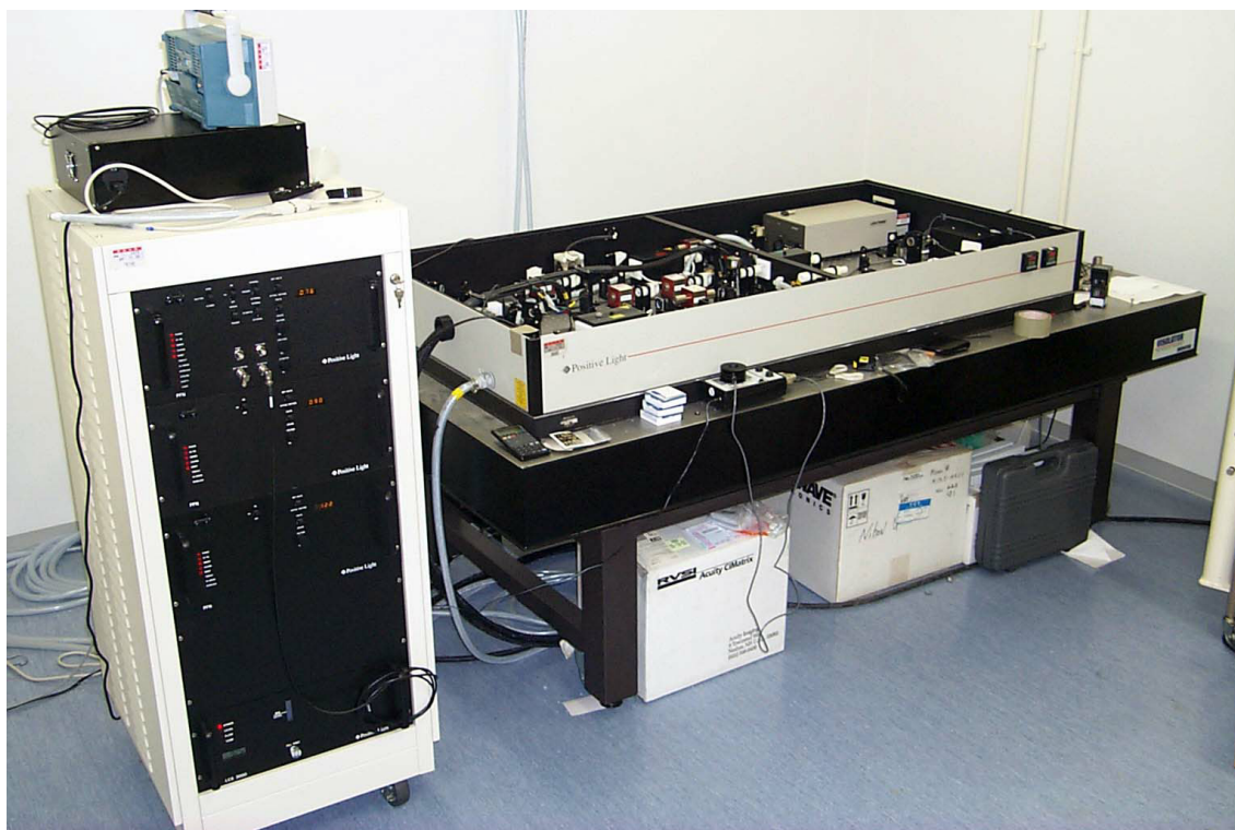
写真 13 高周波電子銃を励起するための YAG レーザーシステム
