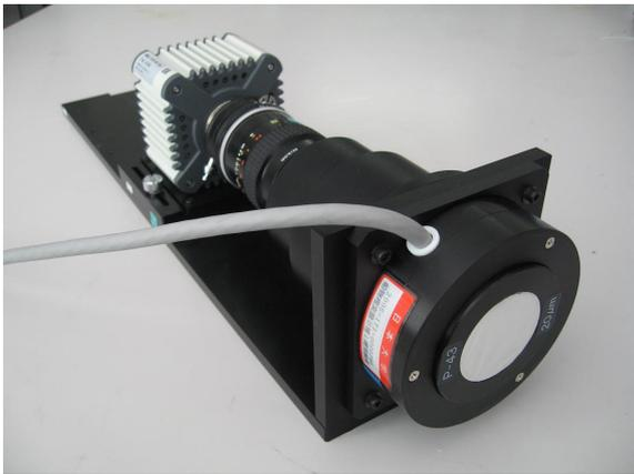
図10 PXR測定用X線冷却CCDカメラ
