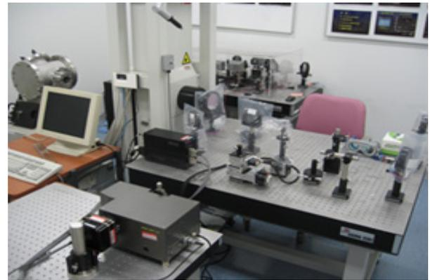
図7 赤外用フォトダイオードアレイ(左:既存の分光器システムに接続設置)及び非線形素子による波長変換光学系(右)
