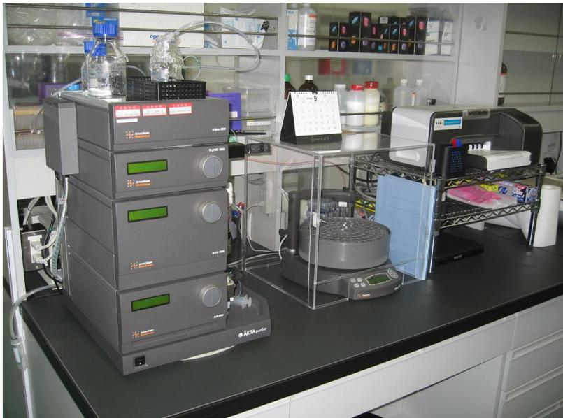
図12 液体クロマトグラフィーシステム (タンパク質精製用)
