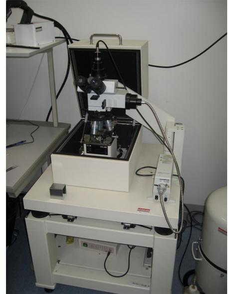
図6 原子間力顕微鏡システム
