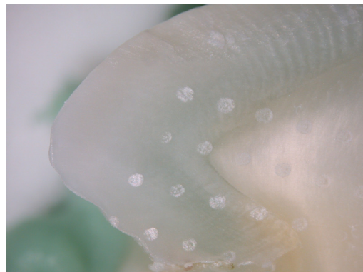
Fig. 2. 波長 3.0 μm の LEBRA-FEL を照射した歯の研磨標本。エナメル質と象牙質にほぼ同程度の pit が形成された。下は一部分の拡大。pit に焦げは見当たらない。
