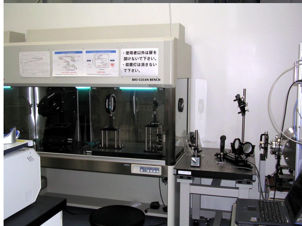
図4. 医学レーザー照射実験室 1 の中にある動物自動飼育装置（写真奥）。手前右は照射用に組み立てた光学系。
