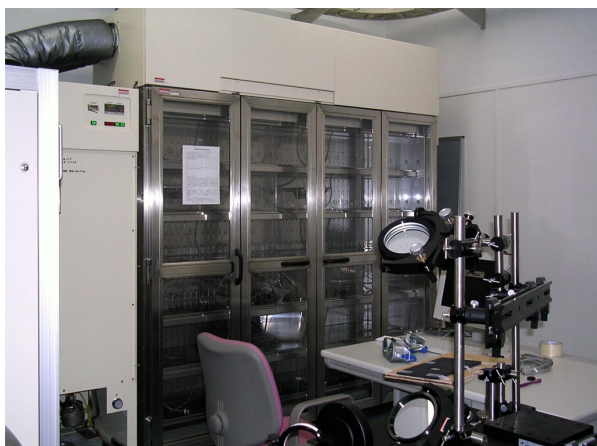
図4. 医学レーザー照射実験室 1 の中にある動物自動飼育装置（写真奥）。手前右は照射用に組み立てた光学系。
